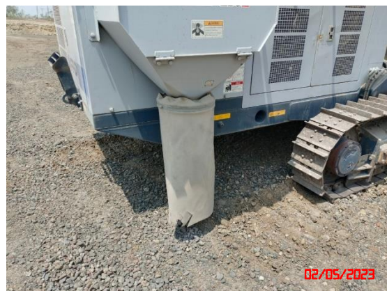
รูปที่ 19 รถเจาะรูระเบิดที่มีอุปกรณ์เก็บฝุ่นละอองติดไว้กับหัวเจาะ
