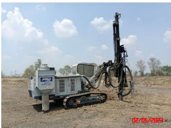
รูปที่ 19 รถเจาะรูระเบิดที่มีอุปกรณ์เก็บฝุ่นละอองติดไว้กับหัวเจาะ
